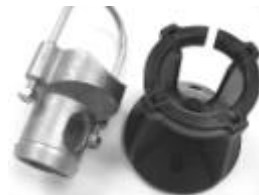
注意喷嘴底部的凸槽轮廓
